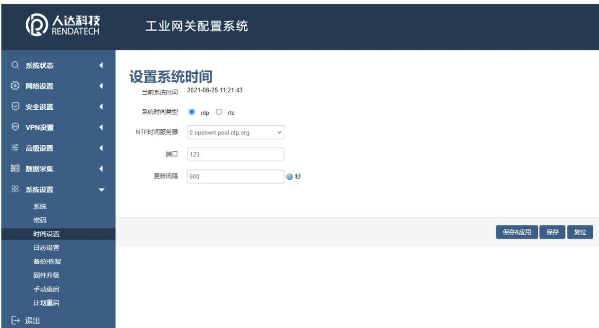
时间类型包括 RTC, NTP; RTC 掉电后, 时间不会丢失; NTP 需要连接到 NTP 服务器, 需要有网络连接, 断电后, 时间不保存。但是 NTP 时间会比 RTC 更精确; RTC 会由于时钟不准, 导致时间不准, 所以需要手动调节。
