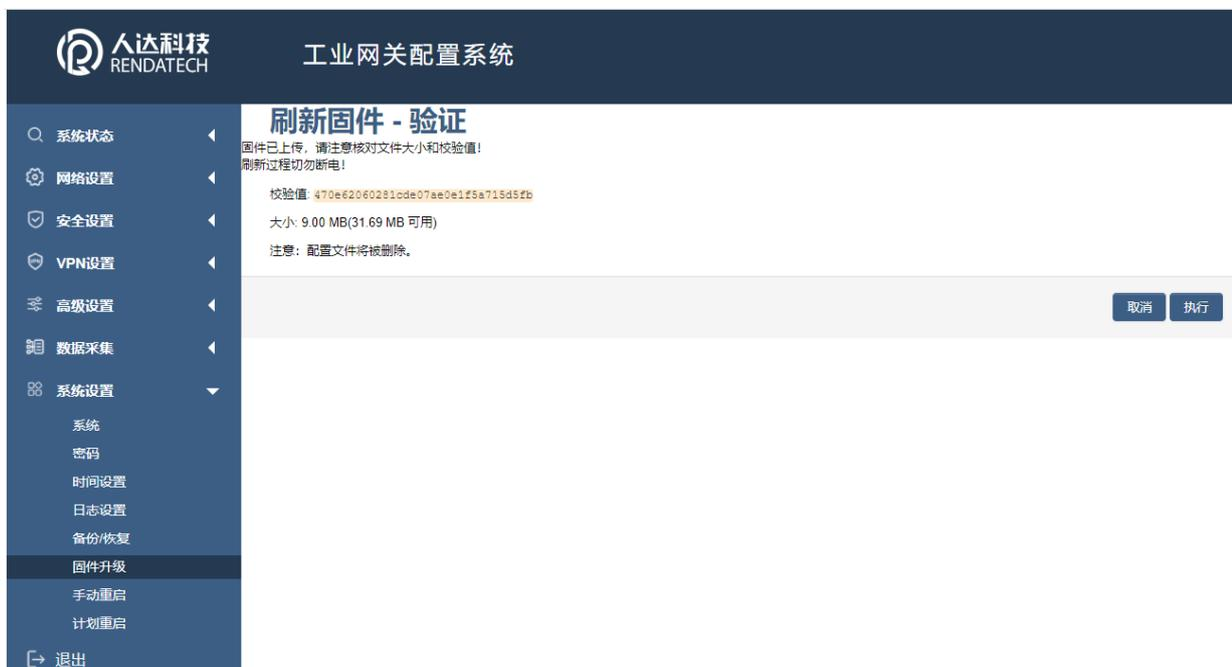
点击“执行”，开始固件升级，待进度条走完设备升级成功，升级成功后进行出厂设置。 注意：执行前可先进行备份配置操作，便于恢复。
