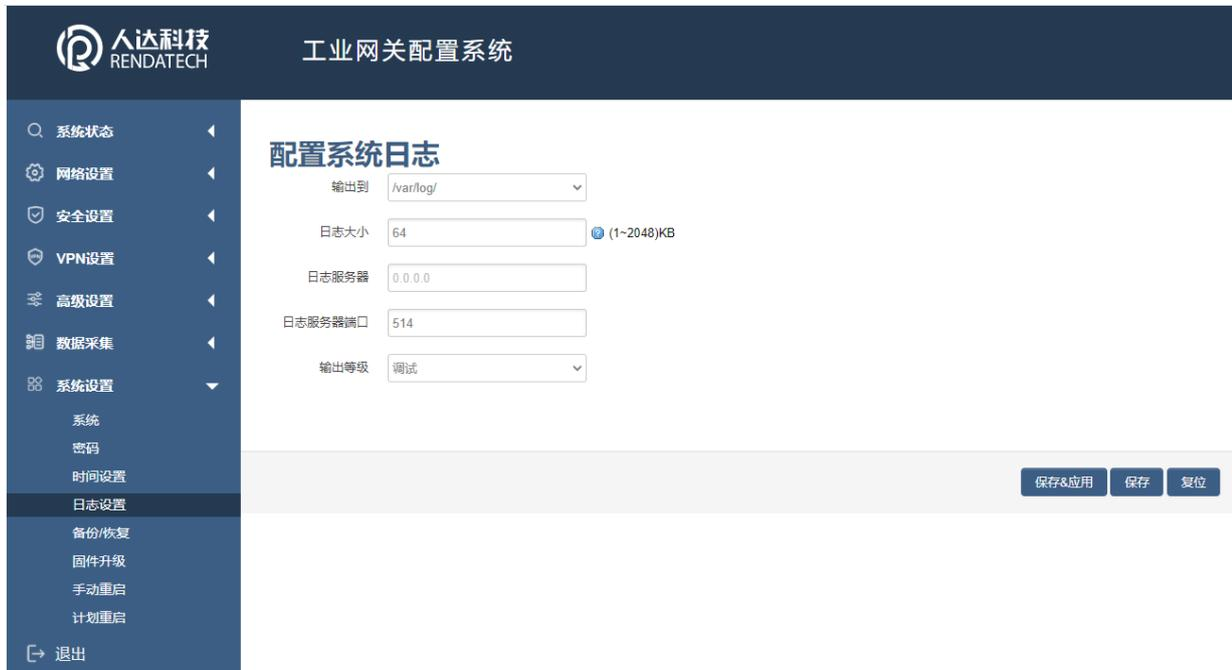
**输出到设备：** 指定日志要输出到哪里，可以输出到串口，也可以输出到用户指定的文件路径，如果有外接存储设备，还可以存储到外接设备，默认路径：`/var/log/`。
