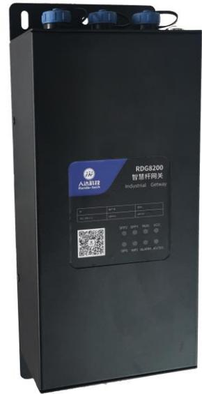
智慧灯杆外设：智能照明、视频监控、环保监测、气象监测、LED 显示屏、无线 WIFI 覆盖、公共广播、一键报警，充电桩，微基站等设备都可以通过 RDG8200 智慧灯杆网关一站式接入及管理，不仅简化项目组网，同时极大提升智慧杆系统的稳定性。
