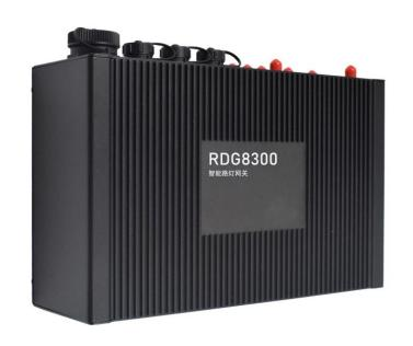
5G 智慧路灯网关 RDG8300 专为 5G 智慧灯杆、泛在电力物联网等场景应用而研发的智能网关,具有强大的设备接入能力、通信协议转换、运算处理能力。该网关可对接智能照明、视频监控、交通指示、交通监控、环境、气象监测、信息发布、公共广播、公共 WLAN、紧急求助、信息交互、充电服务等功能的设备,通过有线、光纤、4G、5G 方式通信。
