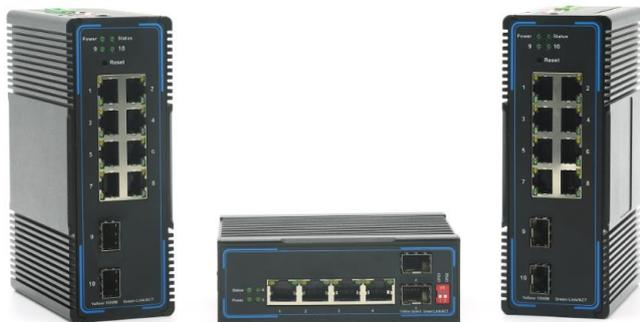
RDS8000 导轨式PoE 工业以太网交换机支持 IEEE802.3af/at 以太网供电标准, 采用先进的自感知算法, 自动检测网络中的 PD 受电设备, 只为支持 IEEE802.3af/at 供电标准的终端设备供电, 不需要去担心会损坏私有标准的 PoE 或非 PoE 设备。自动识别 PoE 需求, 速度, 工作模式和使用网线的类型, 使用简单方便, 无需配置, 即插即用。例如 SC/FC/ST/LC 接口模块。导轨式安装, 宽电压范围输入, 并提供过载和反接保护, 可选宽温型号, 强抗电磁干扰能力, 完全满足苛刻的工业应用环境, 为工业现场提供经济可靠的网络入。
