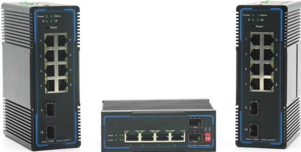
RDS8000 交换机是人达科技推出的新一代绿色节能管理型千兆以太网接入工业交换机，作为极致高性价比的工业交换机，支持 ERPS 环网及一键环网，用以搭建高可用的，安全可靠的工业接入网。可广泛应用于智慧城市，智慧交通，智慧管廊，智慧工业等以太网接入的工业场景。
