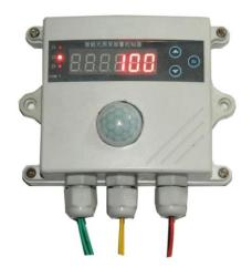
这是一款高精度感光变送器,输出数值计量单位为 Lux,设备采用壁挂防水外壳,壁挂式 安装,防护等 级高。485 通信,标准 ModBus-RTU 通信协议, 通信地址及波特率可设置,最远通信距离 2000 米,产品供电为 10-30V 宽电压供电,主要应用 于农业大棚、花卉培养温 室、农业大田、电子设 备生产线等需要光照度监测的场合。
