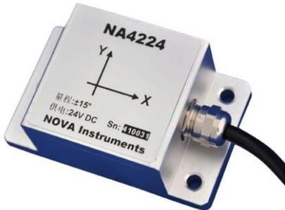
产品内置高精度倾角测量单元，通过测量静态重力加速度，转换成倾角变化，从而可以测量传感器输出相对于水平面的倾斜和俯仰角度。输出方式 RS485 标准接口。
