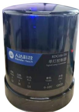
RDC100-TN单灯控制器是专为单体路灯设计的控制终端，可实现单灯经纬时控，定时控，手动控等多种控制模式，智能切换控制模式，智能调节路灯调光、开关等功能，实现按需照明。控制模块采用4G全网通进行数据传输，直接连接到服务器，实现后台软件对单灯的管理，控制器自动检测单灯的工作状态，路灯工作出现异常后及时上报告警，可将路灯系统的故障精确到点。
