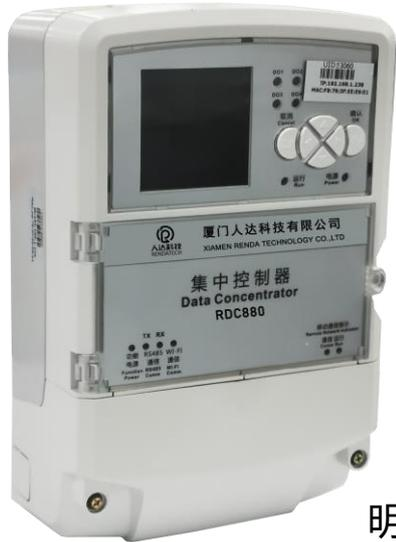
RDC880 集中控制器是城市路灯与夜景智能照明监控系统的核心设备。RDC880 集中控制器采用高性能微处理器，基于多线程 Linux 操作系统进行开发，内嵌便捷配置的 web 服务器，搭载 32MB 大容量存储空间，可以存储几十万条离线数据。
